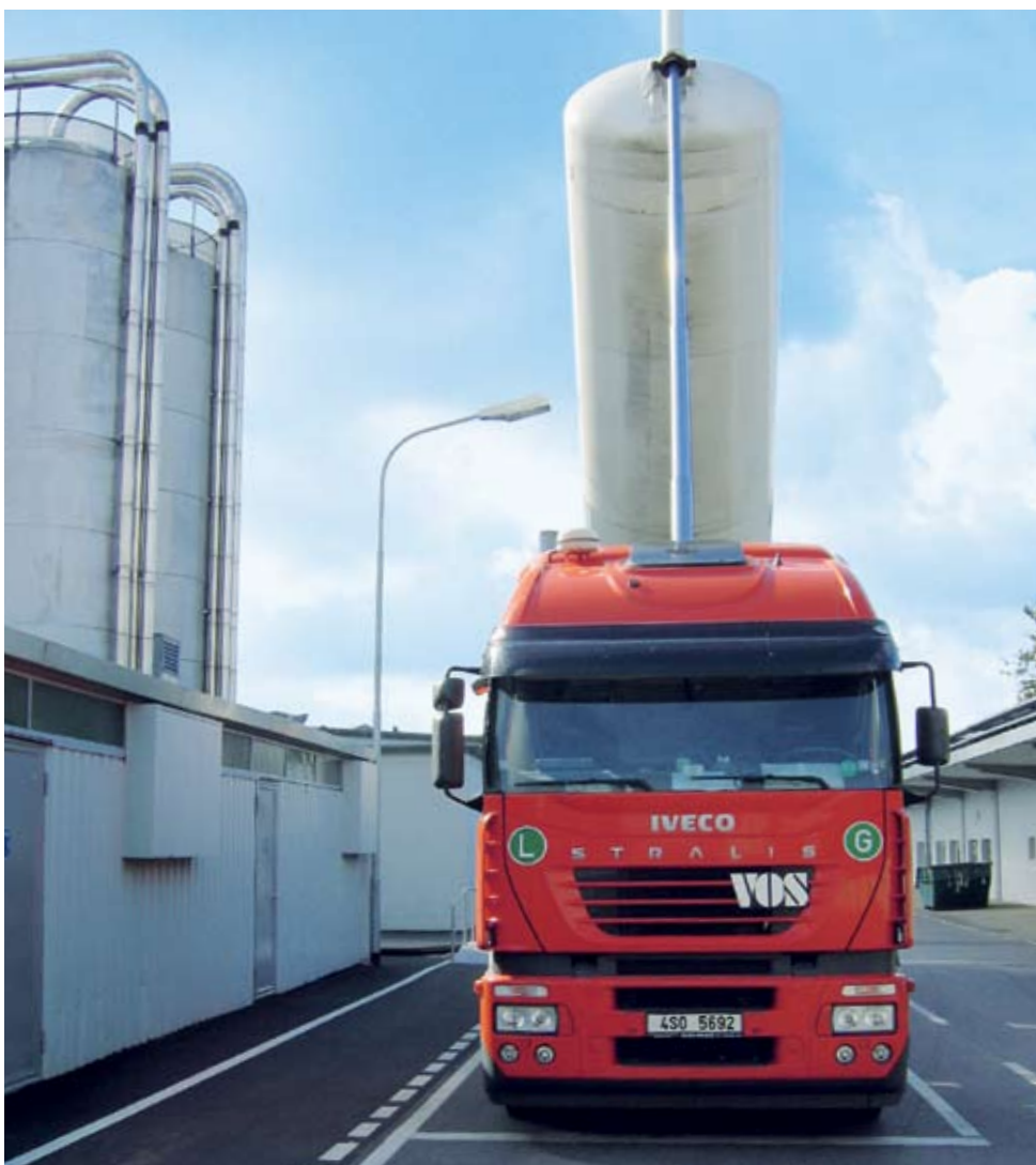
Caminhões descarregam o polietileno.
